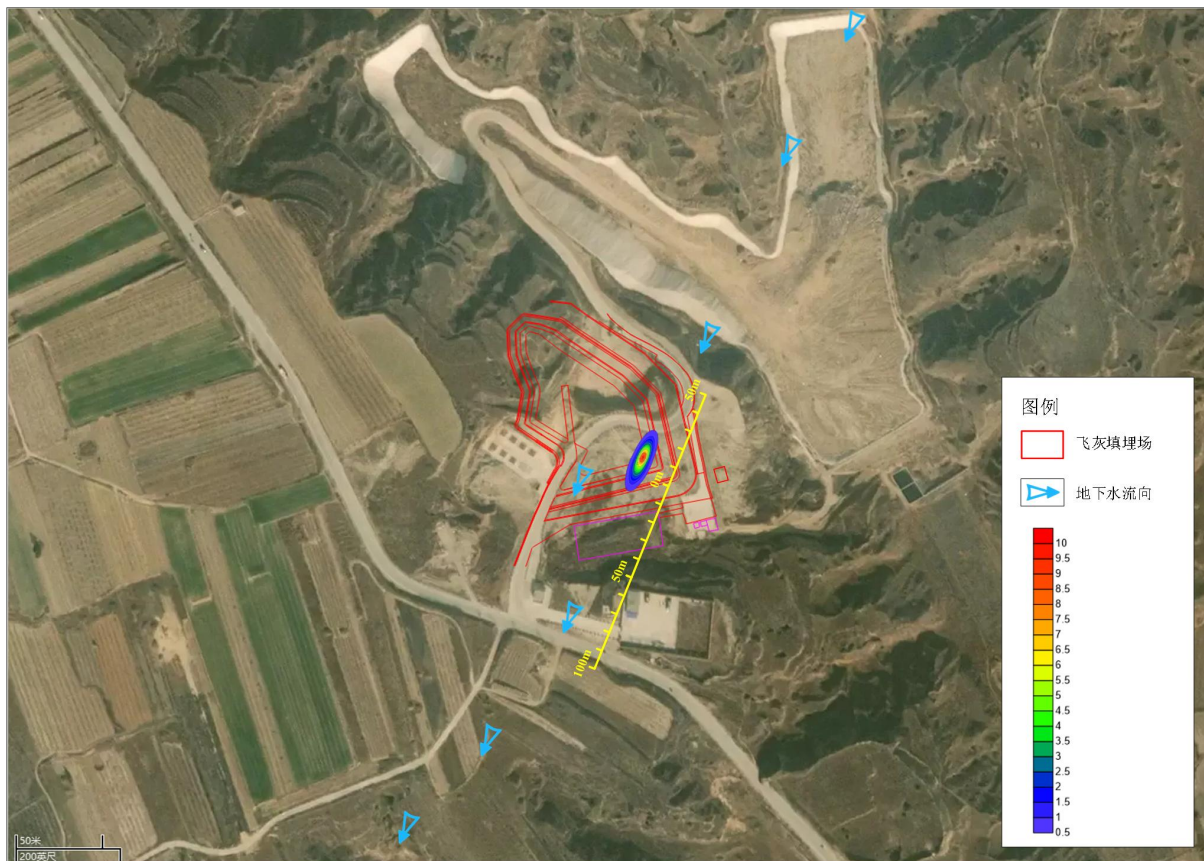
图 5.4-7 飞灰填埋库区发生泄漏 100d 后 COD 影响范围示意图
